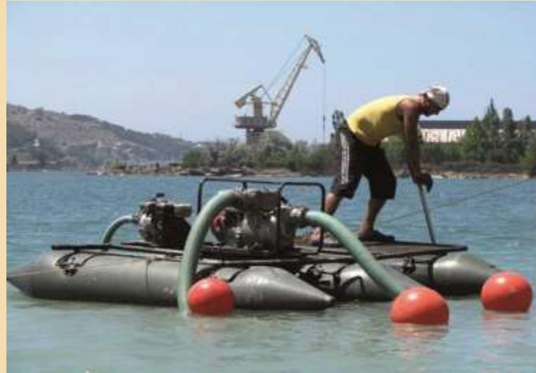
При очистке водоема от химикатов чаще всего применяют подвижные мини земснаряды, оборудованные фильтрационными установками.
